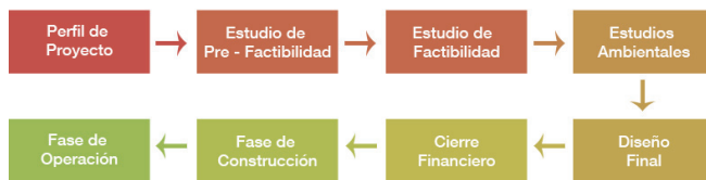
FIGURA NO. 3 ETAPAS DE DESARROLLO DE UN PROYECTO DE PRODUCCIÓN DE ENERGIA RENOVABLE CON FUENTES HÍDRICAS
